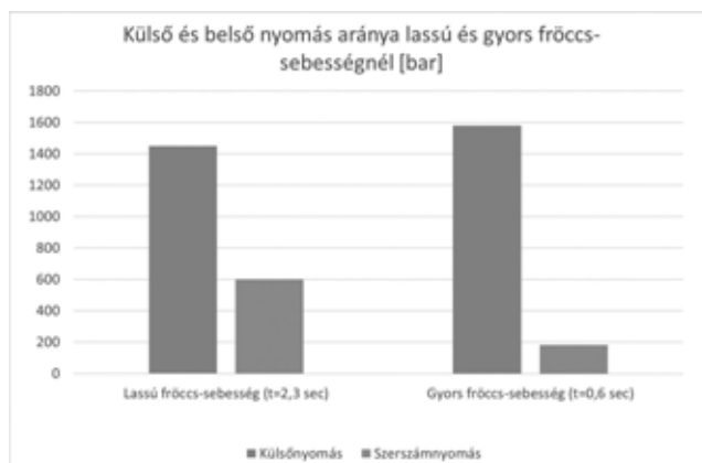
4. ábra. Fröccs-sebesség hatása a külső és belső nyomásra
