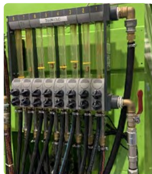
1. ábra: Vízátfolyás mérési megoldások: bal oldalon rotaméterbe szerelt vízátfolyás mérő rendszer – könnyen és gyorsan integrálható meglévő elosztókba; jobb oldalon a Cavity Eye saját fejlesztésű, 8 körös elosztó és vízátfolyásmérő rendszere
